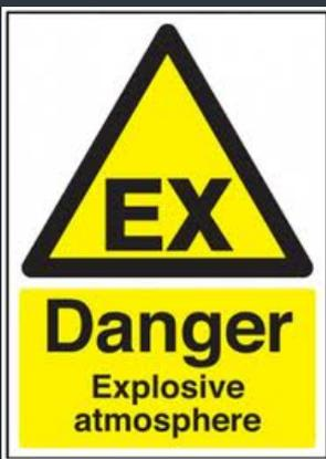
Note : Les appareils photos numériques ne sont pas des appareils Atex (EX). Ils ne doivent pas être utilisés, tout comme les téléphones portables ou les caméra miniatures, type GOPRO ou Contour, dans des atmosphères explosives.
