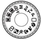
**P - Programme** : L'appareil se charge de régler l'ouverture et la vitesse. Vous pouvez ajuster, corriger l'exposition (ISO).
