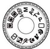
**Av / A - Priorité Ouverture** : Vous fixez l'ouverture et l'appareil ajuste la vitesse correspondante. Ce mode vous permet de contrôler la profondeur de champ, les flous d'arrière plan et la netteté de l'image.
