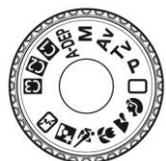
**M - Manuel** : Vous réglez et maîtrisez le réglage de la vitesse et de l'ouverture. Ce mode vous permet de contrôler totalement vos paramètres de prise de vue. Le boîtier n'a aucune action sur les réglages.
