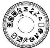
**Tv / S - Priorité Vitesse** : Vous fixez la vitesse et l'appareil ajuste l'ouverture correspondante. Ce mode vous permet de contrôler les flous de sujet, le temps de pose pour donner une dynamique à vos images
